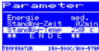
Dies ist die Lötspitzentemperatur bei Arbeitspausen. Sie wird automatisch nach Ablauf der [Standby Zeit] aktiviert. Durch das Absenken der Temperatur wird Energie gespart und die Lebensdauer von Spitze und Heizkörper erhöht.
