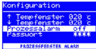
Wenn die Isttemperatur das Temperaturfenster verlässt, ertönt ein einfaches akustisches Signal. Wenn die Isttemperatur wieder in das Temperaturfenster zurückkehrt, ertönt ein doppeltes akustisches Signal. Werkseinstellung: [off].
