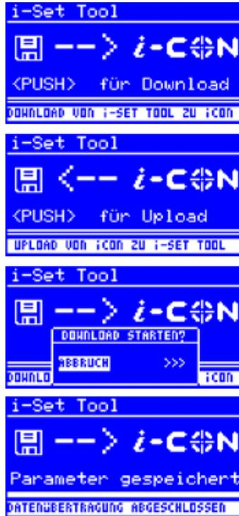
Mit dem i Set Tool (Option) wird ermöglicht, die Einstellungen (inklusive Passwort) der Station zu speichern und wieder in die Station zurückzuschreiben. Somit können Sie die Grundeinstellungen schnell auf mehrere Stationen übertragen. Lesen Sie hierzu die Benutzeranleitung zum i-Set Tool. So nutzen Sie das i-Set Tool:
