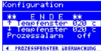
Für das angeschlossene Lötwerkzeug kann ein Temperaturfenster mit einem oberen und unteren Bereich definiert werden.
