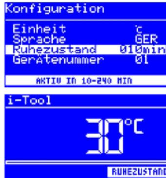
Die einstellbare Shut-down Funktion (Ruhezustand) dient der Energieeinsparung und der Verlängerung der Lebensdauer von Lötspitzen und Heizkörper. Im Ruhezustand kühlen die Werkzeuge bis zur Raumtemperatur ab. In der unteren Displayzeile wird dann der Text [Ruhezustand] angezeigt. Sie können den Ruhezustand jederzeit beenden, indem Sie den i-OP betätigen.
